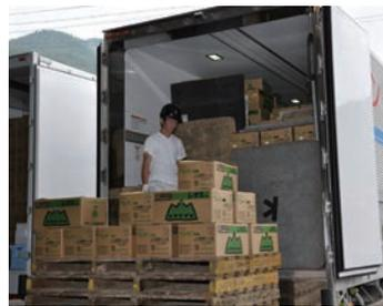
冷蔵機能がついた冷蔵車というトラックで、荷台を低温に保ち、高速道路を使ってその日のうちに東京の市場へ運びます。運転中にも温度のチェックがかせません。
