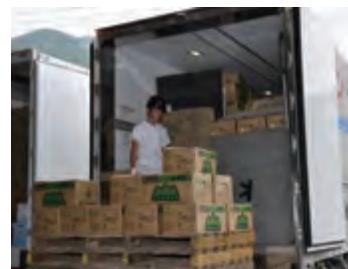
冷蔵機能がついた冷蔵車というトラックで、荷台を低温に保ち、高速道路を使ってその日のうちに東京の市場へ運びます。運転中にも温度のチェックがかけません。
